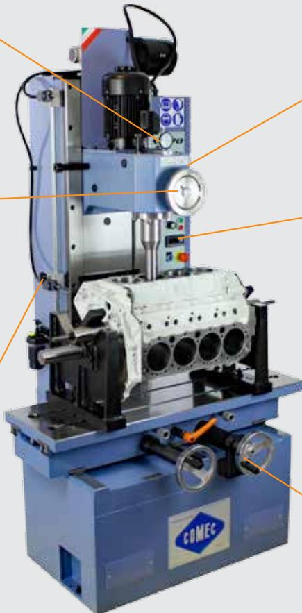
Pannello comandi con potenziometro per la regolazione velocità mandrino e display lettura del nr. di giri •
